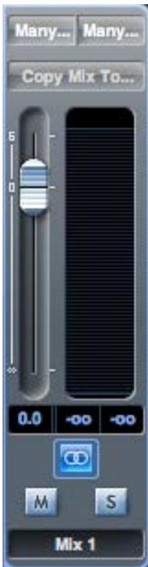
Toutes les voies d'entrée sont mixées entre elles et routées vers la voie de sortie du mélangeur. La voie de sortie vous permet de contrôler le niveau général de la totalité du mixage (rappelez-vous qu'il y a une voie de sortie séparée pour chacun).
