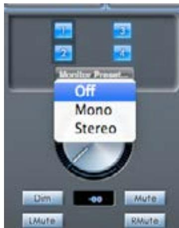
Une gamme de configurations d'écoute préréglées est fournie ; cliquez sur le bouton Monitor Preset... pour ouvrir une liste déroulante. Ces presets permettent une sélection simple des configurations d'écoute de contrôle courantes.
