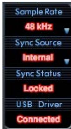
La section Statut d'appareil affiche des informations sur la fréquence d'échantillonnage, la synchronisation et le statut de pilote de la Scarlett 6i6. La fréquence d'échantillonnage et la source de synchro peuvent également se régler ici.
