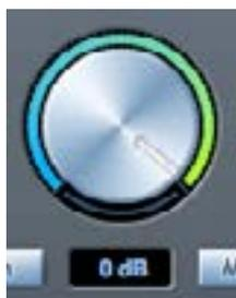
Réglez le niveau de sortie avec cette commande pour toutes les sorties sélectionnées, au moyen de la souris. L'affichage numérique du dessous indique le niveau de sortie d'écoute actuel.
