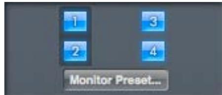
Ces boutons déterminent quelles sorties lignes de la Scarlett 6i6 sont affectées par les autres commandes de la section Monitor de l'interface graphique utilisateur, et également par les commandes d'écoute de la face avant. Selon votre configuration d'écoute de contrôle, vous pouvez ne piloter aucune enceinte, une seule enceinte ou jusqu'à 4 enceintes simultanément.
